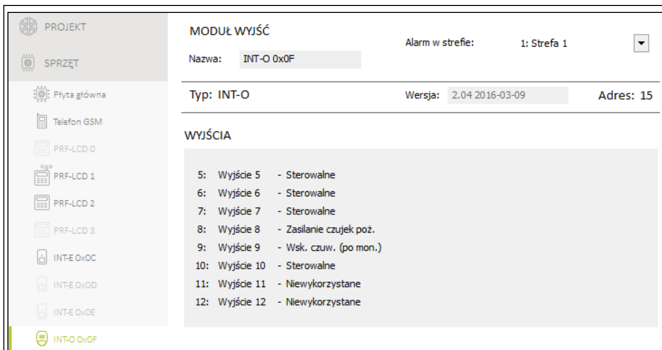
Rys. 13. Zakładka z ustawieniami ekspandera wyjść.
